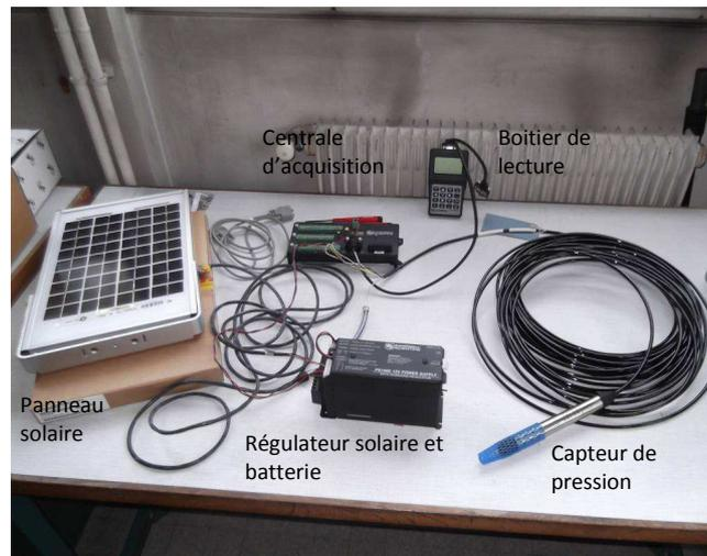
Figure 11 : Matériel nécessaire
