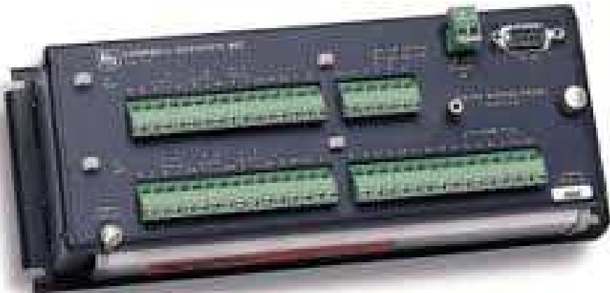
Centrale d'acquisition CR10
