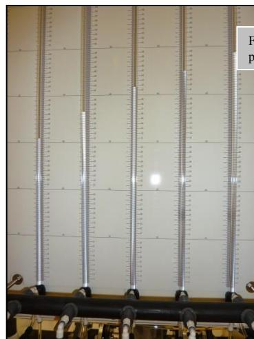
Fig. 3: tube 0 et tubes piezométriques
