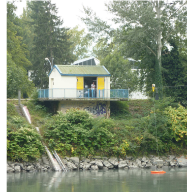
Fig. 1 : vue extérieure : à gauche l'échelle limnimétrique et les tubes des capteurs. A droite, le chariot et les câbles de la traîlle avec l'ADCP sur son catamaran en mesure
